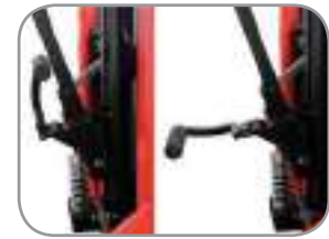
Pedal de elevación abatible
