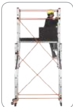
Acceso a la plataforma con trampilla por el interior del andamio
