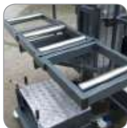
Plataforma portaféretros plegable equipada con correas de sujeción
