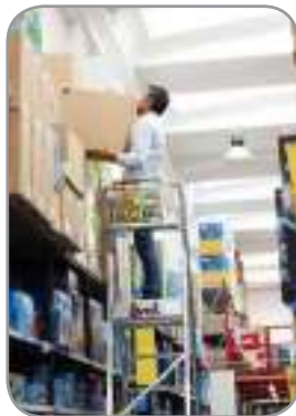
Bandeja para cargas 15 kg de capacidad
