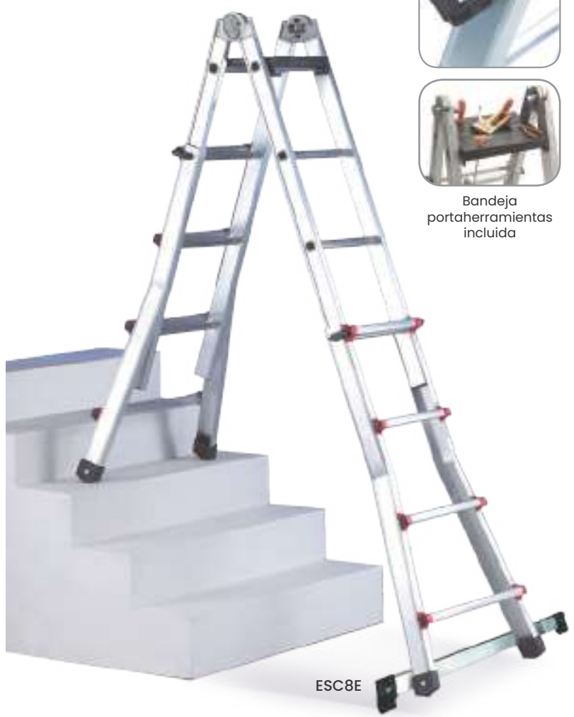
OBLIGATORIO: Según la nueva norma EN131, la base estabilizadora es obligatoria para escaleras de más de 3 m de altura en apoyo
