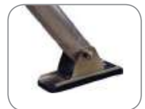
Estabilizadores equipados con zapatas basculantes
