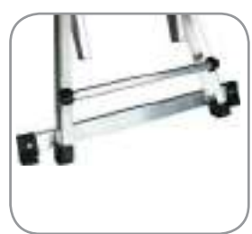
OBLIGATORIO: Según la nueva norma EN131, la base estabilizadora es obligatoria para escaleras de más de 3 m de altura en apoyo
