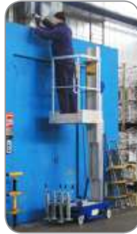
Puede trabajar sin husillos niveladores hasta una altura de plataforma de 1,70 m
