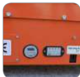
Toma de corriente para la carga de la batería en el bastidor
